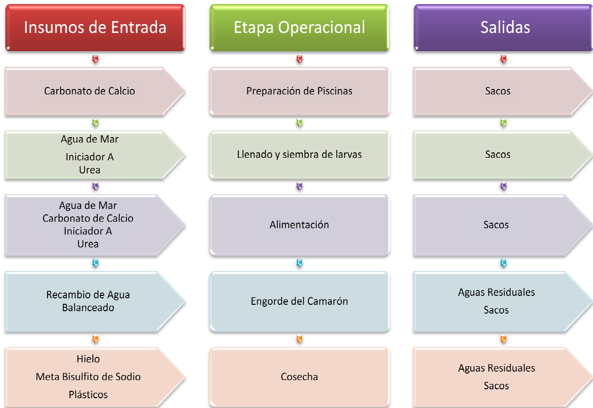
Figura 3.11 Flujo del Proceso de Producción
