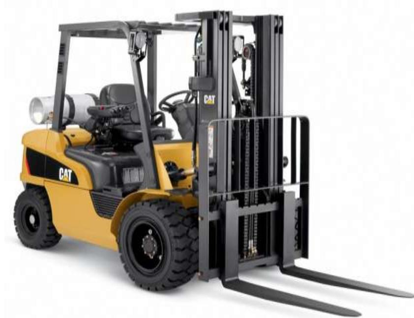
Figura 8 Montacargas Clase V.
