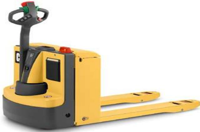
Figura 6 Montacargas Clase III
