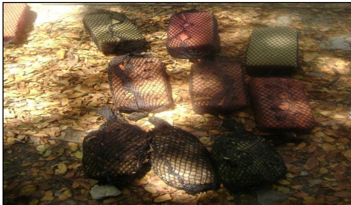
Figura 3. Fotografía de los sustratos artificiales previo a la instalación. Los tres sustratos superiores son de esponja, los tres de la mitad son de ladrillo y los tres inferiores son de biomasa.
