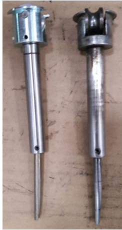
Figura 17. Vástago regulador de combustible
