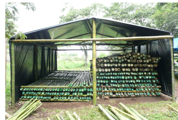
Figura 55: Secado y almacenamiento bajo techo
