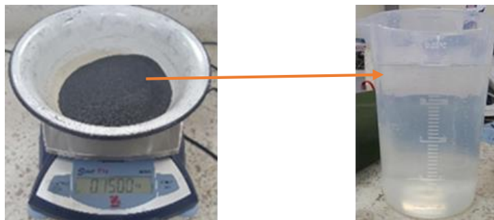
Figura 11. Incorporación de 0.15 kg de grafito en 2 litros de agua.
