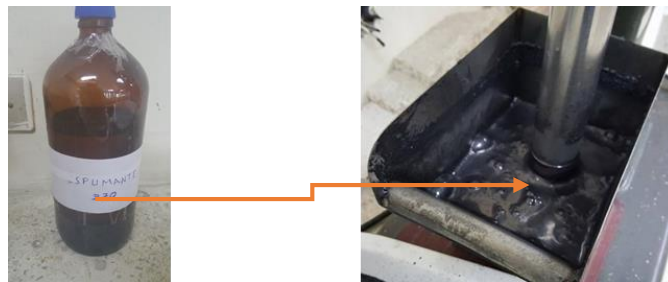
Figura 14. Incorporación de 5 gotas de espumante 370 a la pulpa.
