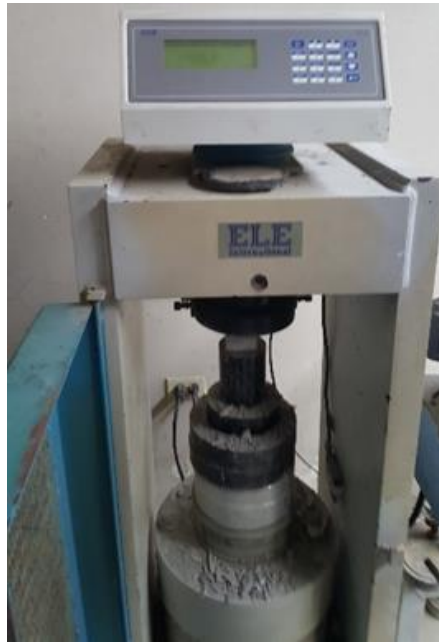
Figura 42. Máquina para ensayar los cubos de mortero a compresión.
