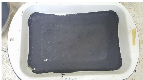
Figura 17. Espuma de la pulpa luego de 24 horas en el horno.
