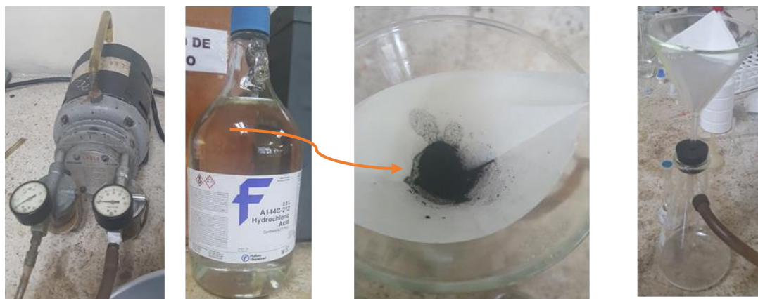
Figura 32. Proceso de filtración para obtener óxido de grafeno.
