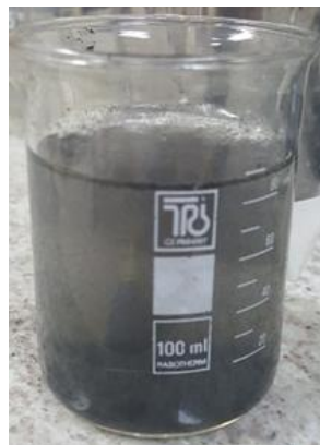
Figura 37. Mezcla de óxido de grafeno y agua con policarboxilato.
