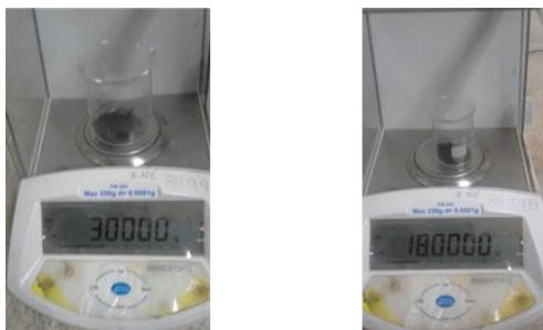
Figura 23. Pesaje de 3g de grafito. 18 g de permanganato de potasio.
