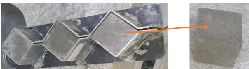
Figura 41. Desmontaje de cubos de mortero con óxido de grafeno.
