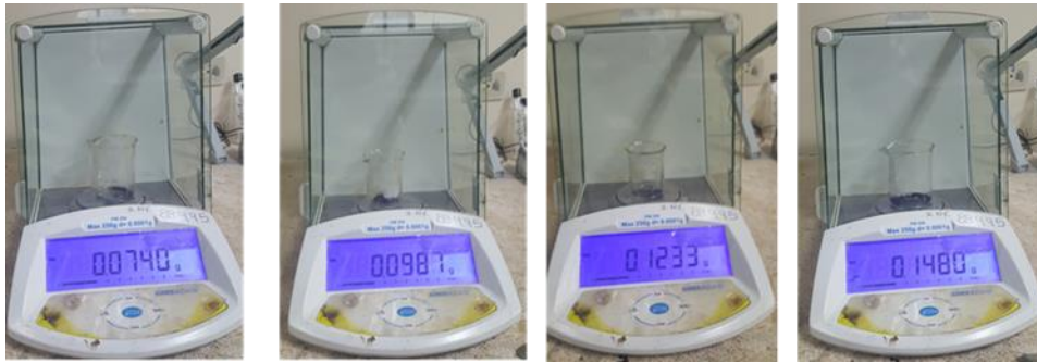
Figura 36. Peso de diferentes porcentajes de óxido de grafeno: (0,03%-0,04%-0,05%-0,06%) para 3 especímenes por porcentaje.
