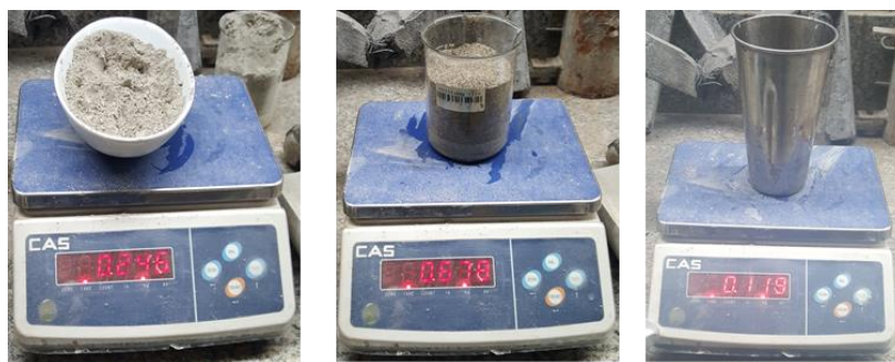
Figura 34. Pesaje de cemento, arena y agua.
