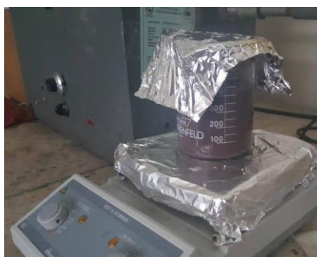
Figura 27. Agitación de mezcla a 50° C durante 12 horas.
