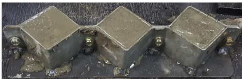
Figura 40. Moldes metálicos con mortero.
