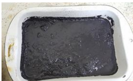
Figura 15. Bandeja con espuma resultante del proceso de flotación.
