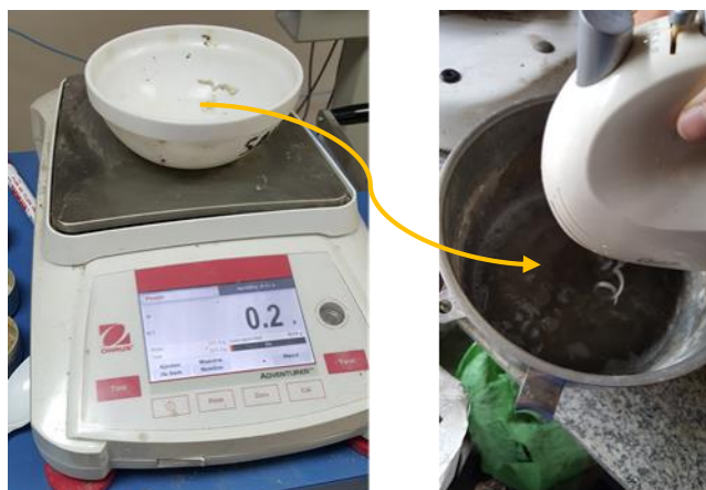
Figura 35. Pesaje de polycarboxilato para posteriormente ser mezclado con el agua.
