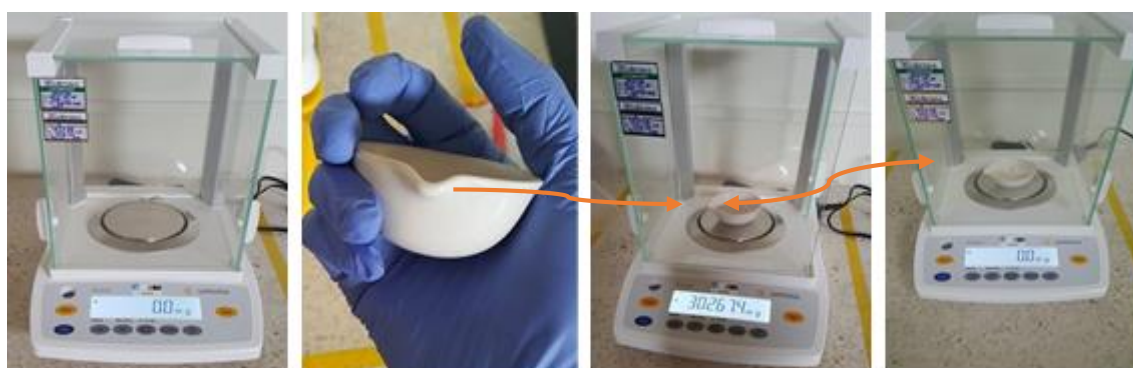
Figura 18. Calibración de la balanza electrónica: Sartorius. Modelo: ED2245.
