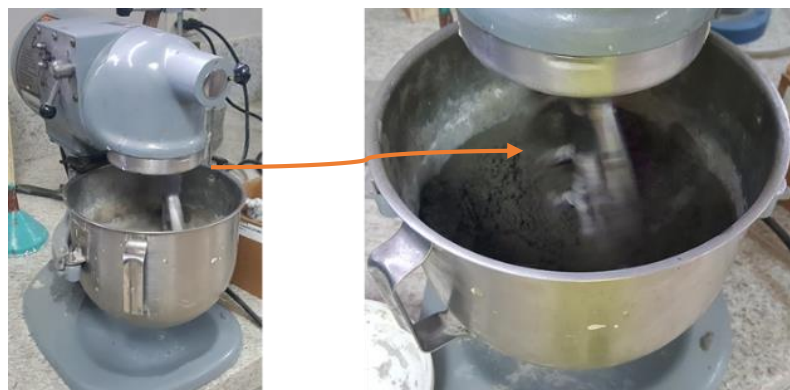
Figura 38. Mezcla de materiales que componen el mortero con policarboxilato y óxido de grafeno.
