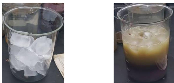
Figura 28. Mezcla con hielo desionizado y 6ml de peróxido de hidrógeno.
