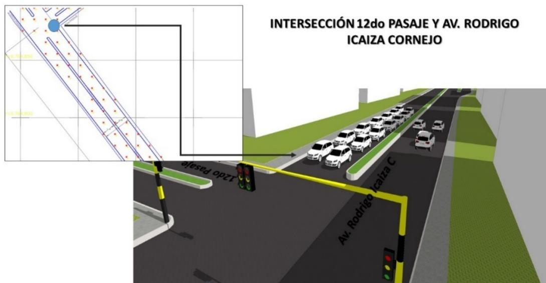
Figura 23. Propuesta de semaforización inteligente en la intersección del 12do pasaje con la Av. Rodrigo Icaiza Cornejo
