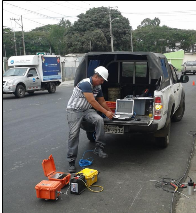
Figura 28. Ensayo de Método de Nakamura, realizado en la ciudad de Guayaquil por la empresa Geoestudios S.A.
