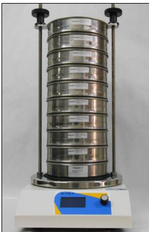
Figura 18. Juego de tamices para realizar los ensayos de granulometría.
