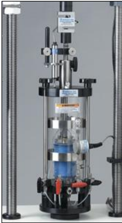
Figura 20. Cámara para ensayos triaxiales. Tomado y modificado de http://www.estudiosgeotecnicos.info/index.php/ensayos-de-laboratorio-resistencia-de-los-suelos-3-ensayo-triaxial .
