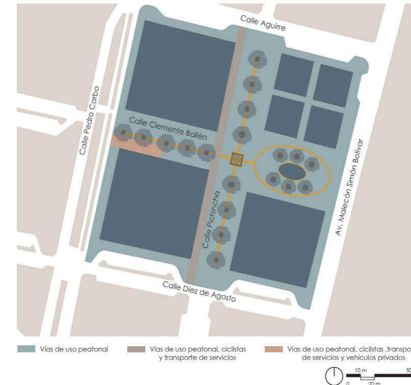
Figura 60. Esquema de tipologías de vías de la Plaza de la Administración. Fuente: (Elaboración propia, 2020)
