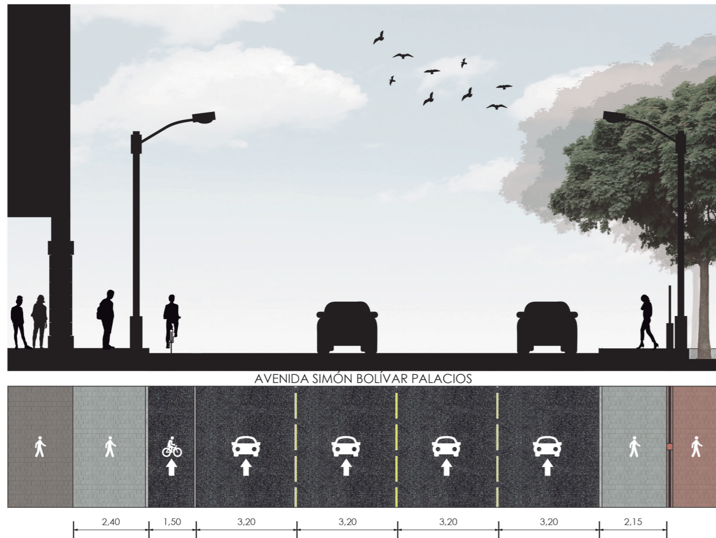
Figura 83. Sección de Vía Primaria. Fuente: (Elaboración propia, 2020)
