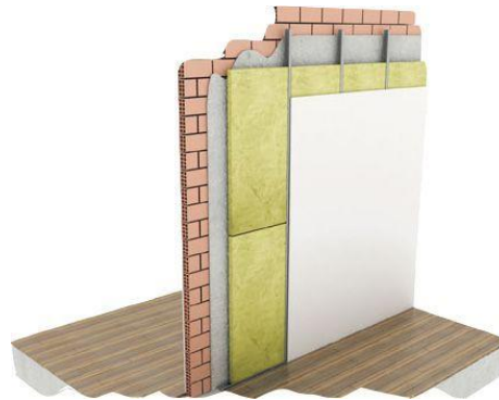
Imagen N°9. 5. Lana de Roca en Paredes Fuente: BlogSpot (2015)
