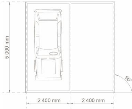
Imagen N°2. 15. Dimensiones mínimas para vehículos tipo N1 y M1 Fuente: Norma Técnica Ecuatoriana INEN 2248 (2016)
