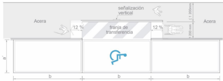
Figura. 14 Plazas de estacionamiento en paralelo para personas con discapacidad o movilidad reducida Fuente: (INEN, 2018)
