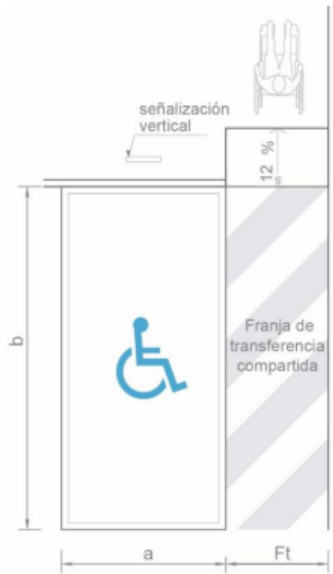
Figura. 17 Señalización horizontal para plazas de estacionamiento para personas con discapacidad y movilidad reducida
