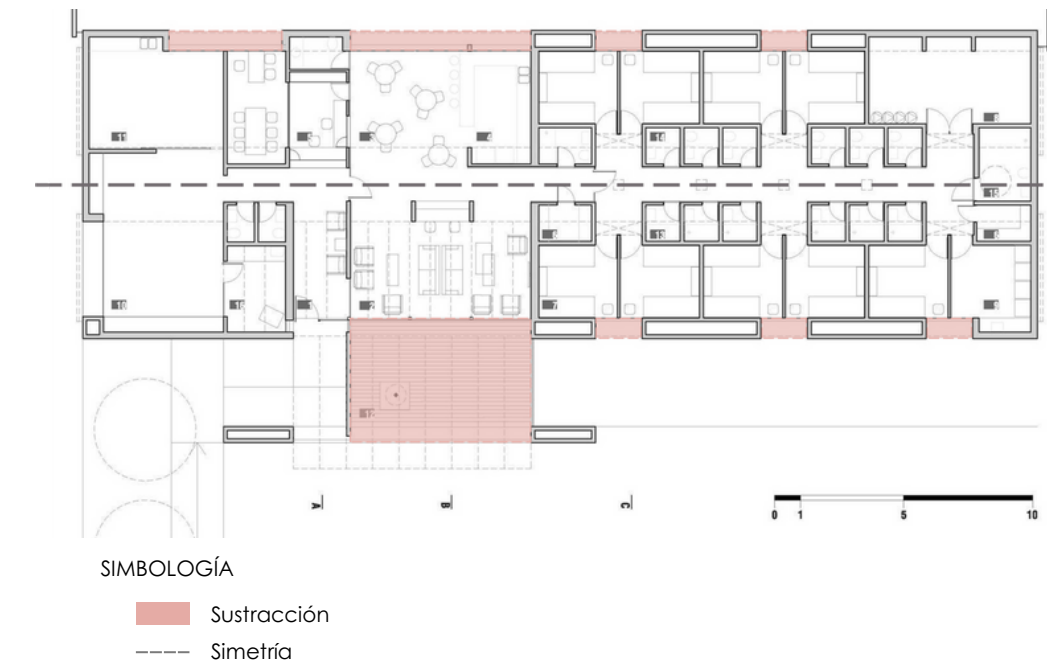
ILUSTRACIÓN 6 Planta Arquitectónica con ordenadores espaciales de Casa Ronald McDonald en Uruguay. Recuperado de ARQA.com. Análisis Propio.
