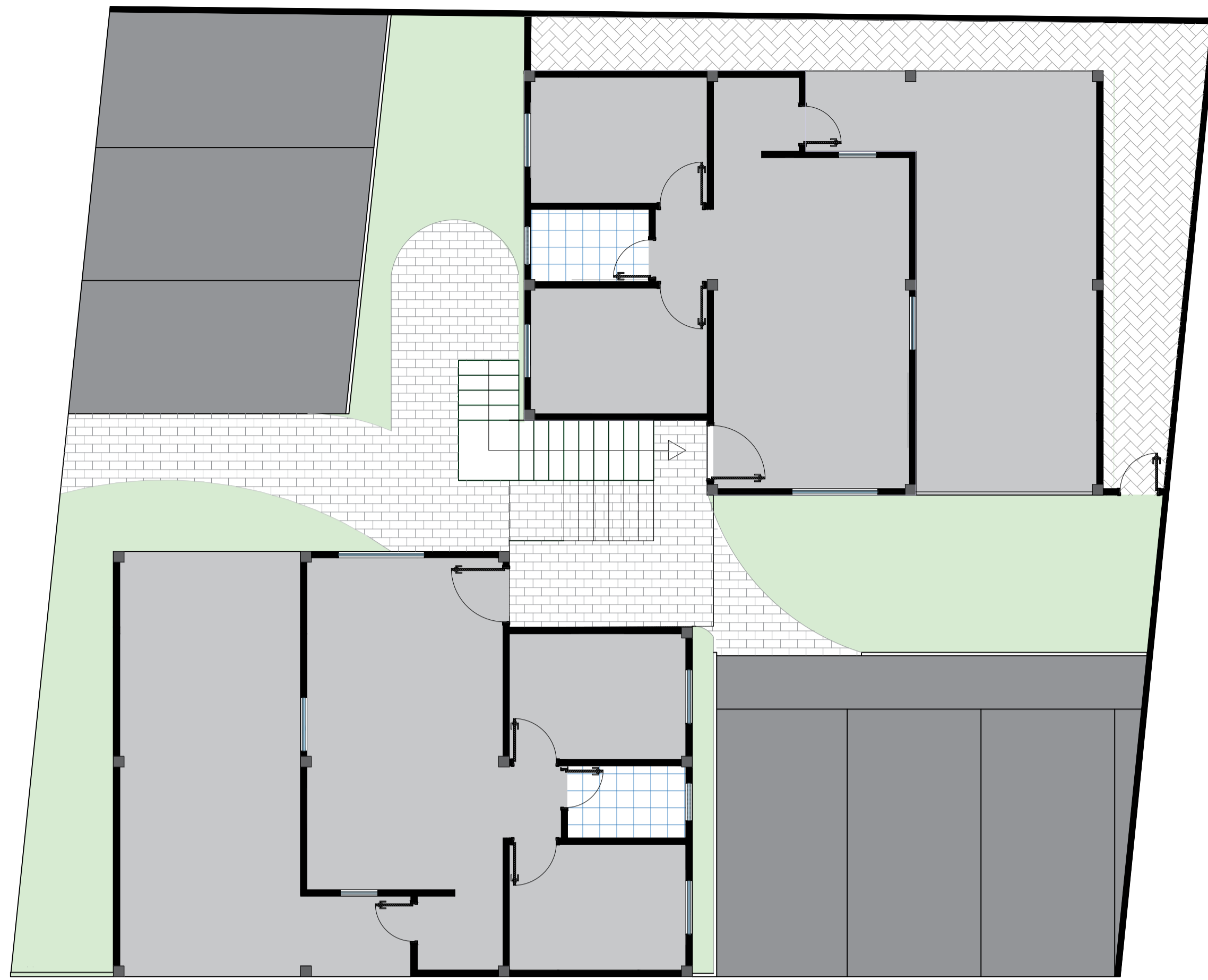
PLANTA BAJA PROTOTIPO 3 AREA: 49,09 m2 AREA EXPANSIÓN: 30,85 m2
