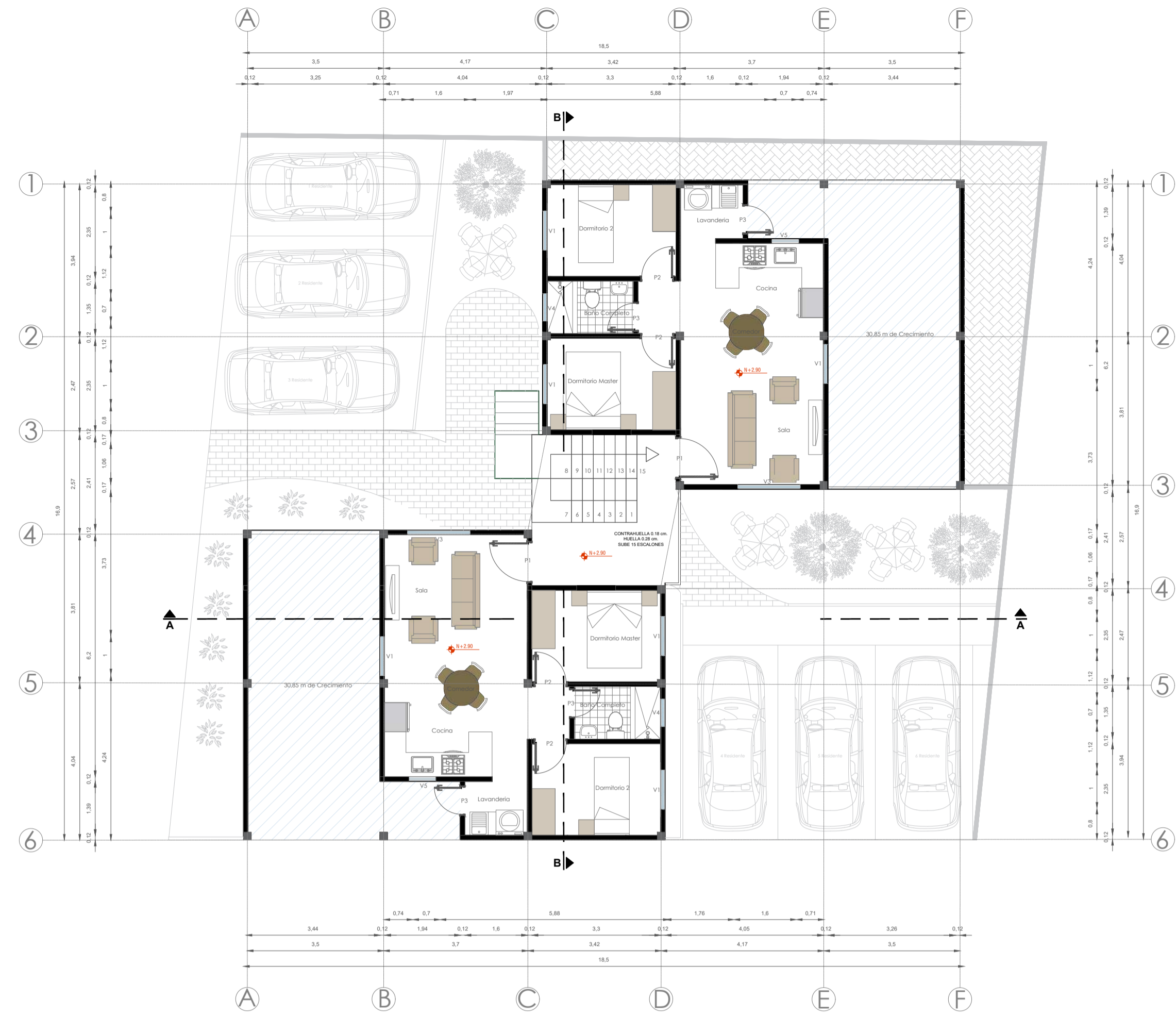
PRIMERA PLANTA PROTOTIPO 3 AREA: 49,09 m 2 AREA EXPANSION: 30,85 m 2
