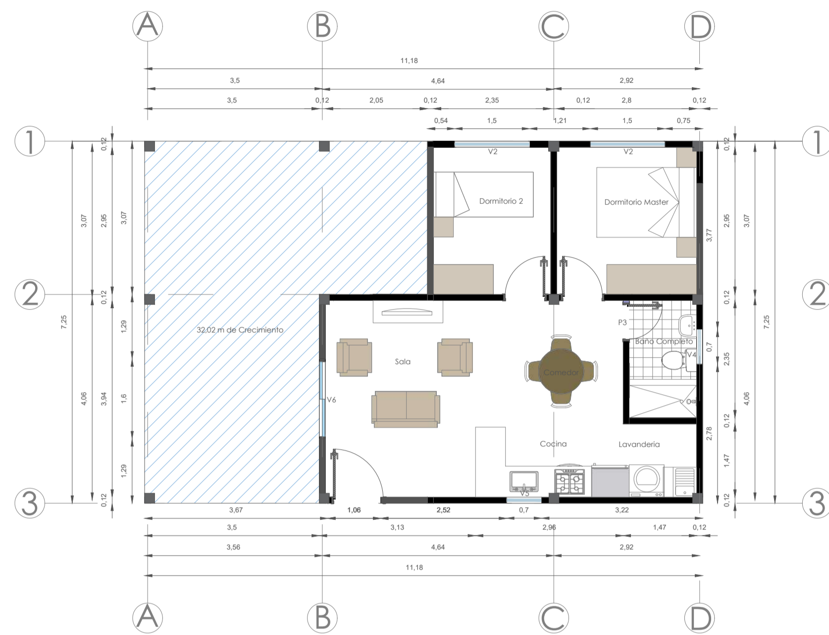
PROTOTIPO 2 AREA: 49.10 m 2 AREA EXPANSIÓN: 32.02 m 2
