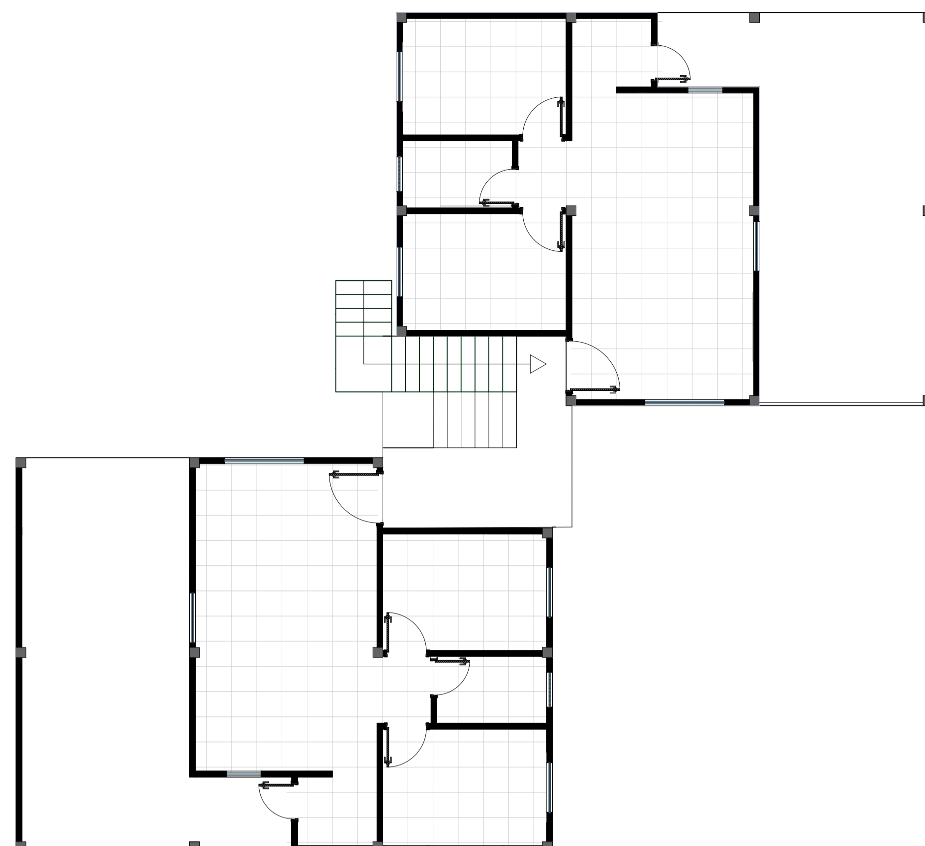
PLANTA BAJA PROTOTIPO 3 AREA: 49.09 m2 AREA EXPANSIÓN: 30,85 m2
