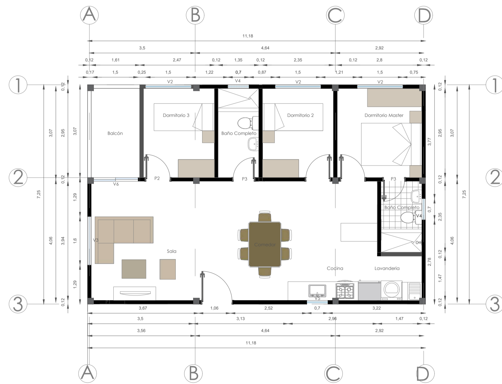
PROTOTIPO 2 AREA: 49.10 m 2 AREA EXPANSIÓN: 32.02 m 2
