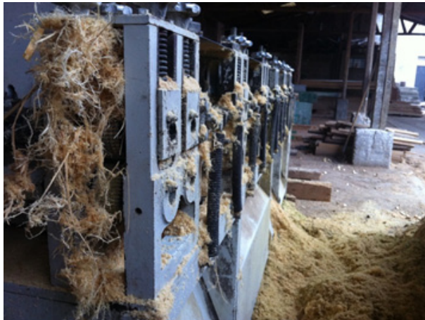
Imágen N°130: Proceso de cepillado de latillas en fábrica de Madel. Fuente: Elaboración propia Enero 03 de 2014.
