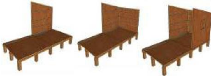
Ilustración 21: Forma de colocar las paredes. Fuente: Manual para la construcción de Un techo para mi País.
