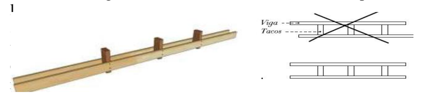
Ilustración 24: Detalle de Vigas. Fuente: Manual para la construcción de Un techo para mi País.
