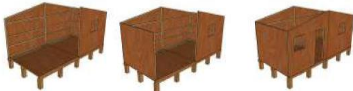
Ilustración 22: Forma de concluir la colocación de paredes. Fuente: Manual para la construcción de Un techo para mi País.
