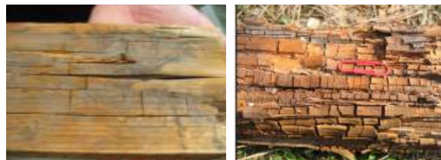
Gráfico 29 Contiene: Pudrición parda de la madera Fuente: CIS-madeira, 2007
