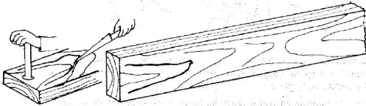
Gráfico 76 Escamadura Fuente: Manual de diseño de maderas para el grupo andino (1980)
