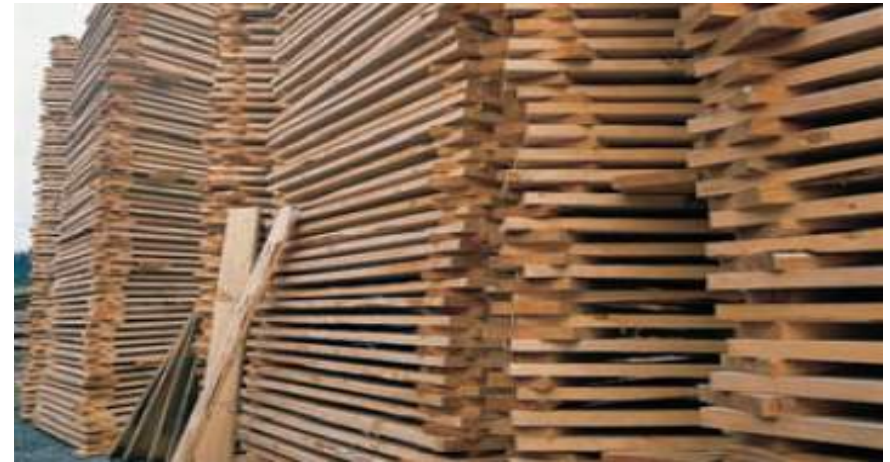
Gráfico 21 Secado de la madera al aire libre Fuente: La madera y sus derivados, 2013
