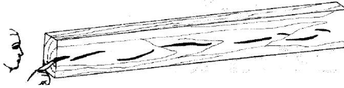
Gráfico 75 Duramen quebradizo Fuente: Manual de diseño de maderas para el grupo andino (1980)
