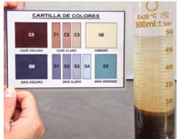
ENSAYO DE COLORIMETRÍA - ARENA
