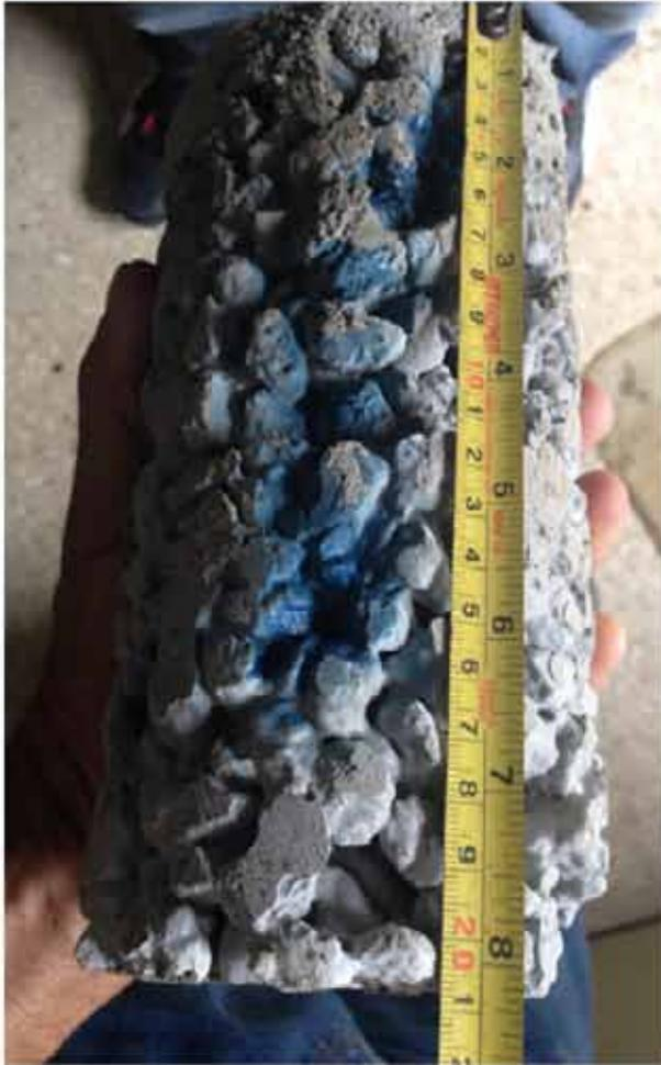
REGISTRO DE MEDICIÓN DEL DIAMETRO Y ALTURA DE LA MUESTRA CILINDRICA - PREVIA ROTURA
