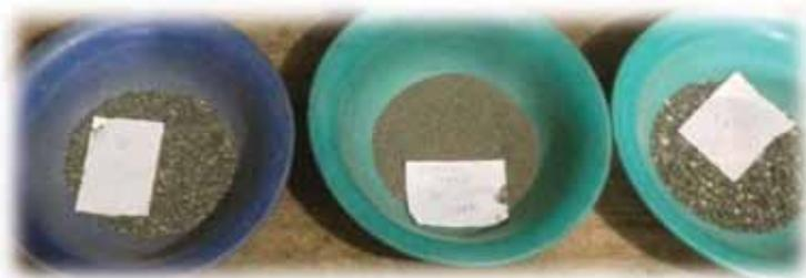
Figura 4.8 - Ensayo para determinar la solidez del agregado mediante el uso sulfato de sodio o sulfato de magnesio según la norma ASTM C 88.
