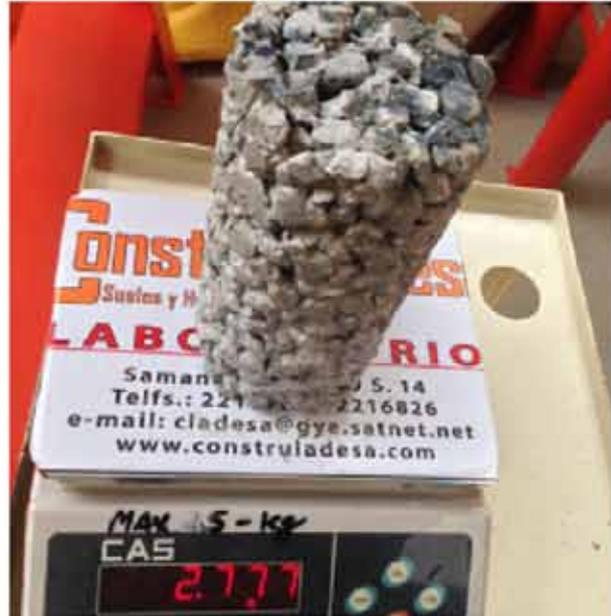
REGISTRO DEL PESO DE LA MUESTRA CILINDRICA - PREVIA ROTURA - DISEÑO #1
