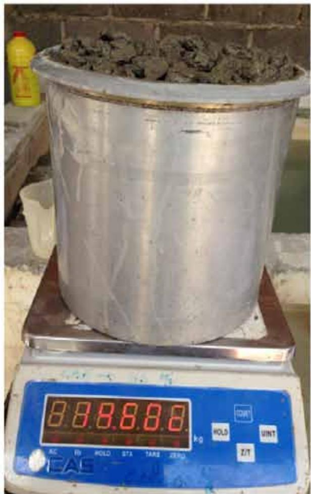
ENSAYO PARA DETERMINAR LA DENSIDAD
