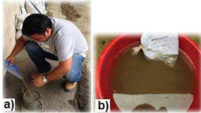
a) Peso volumétrico suelto (PVS), b) absorción y gravedad específica.
