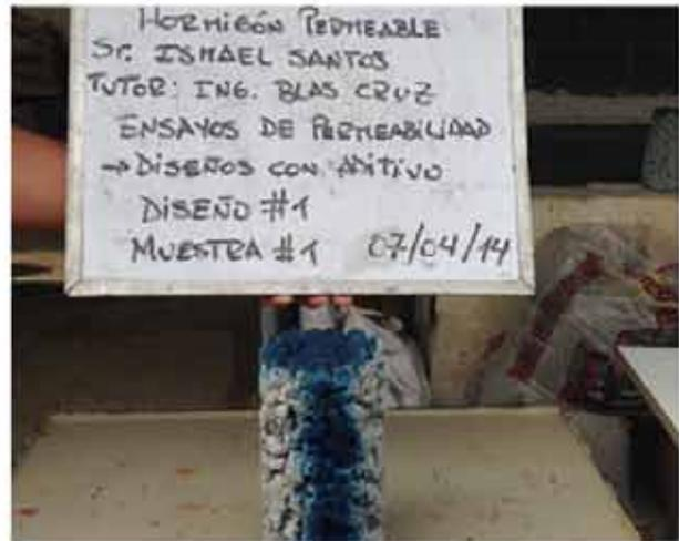
MUESTRA DE HORMIGÓN (CILINDROS) - PREVIO ENSAYO
