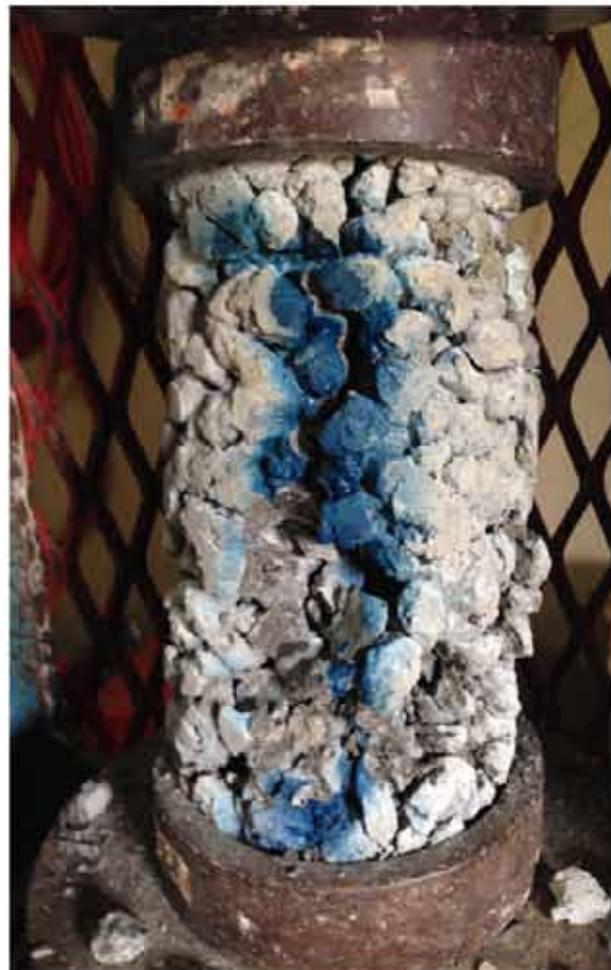
ROTURA DE LA MUESTRA CILINDRICA - ENSAYO A LA COMPRESIÓN - DISEÑO #1
