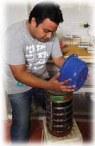
Figura 4.2 - Ensayo para determinar la granulometría de los agregados según la norma ASTM C33.
