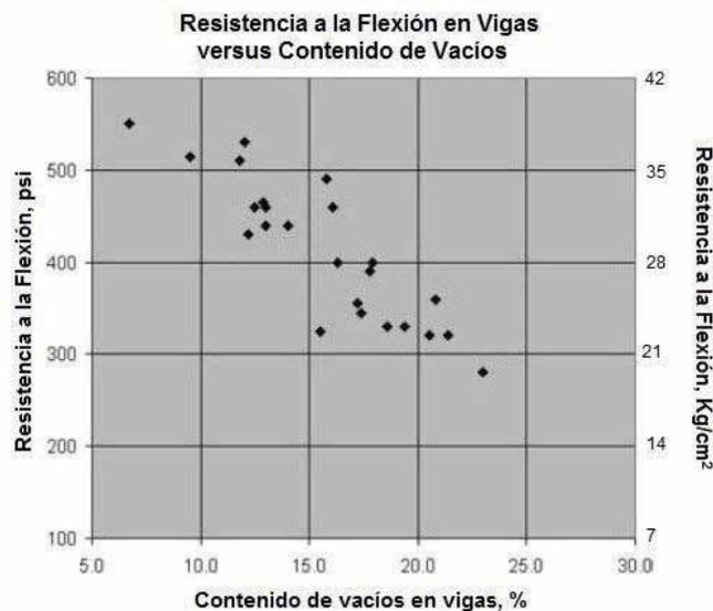
Figura 2.10 – Gráfico de la resistencia a la flexión en vigas versus contenido de vacíos(Meininger, 1988).
