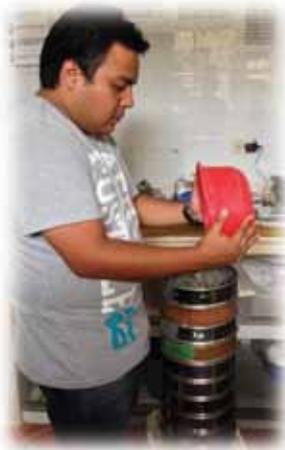
Figura 4.6 - Ensayo para determinar la granulometría de los agregados según la norma ASTM C33.
