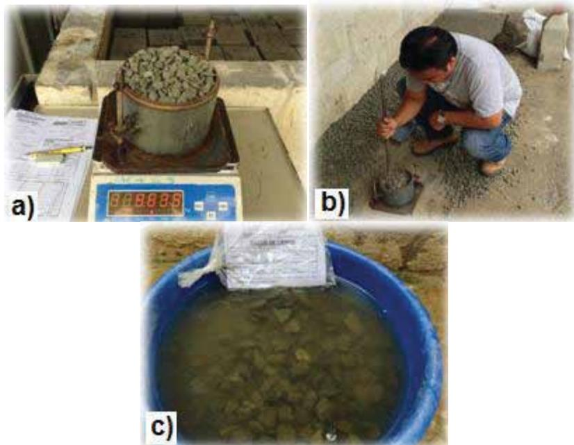
a) Peso volumétrico Suelto (PPV), b) Peso volumétrico Varillado (PVV), c) Absorción y Gravedad Específica.
