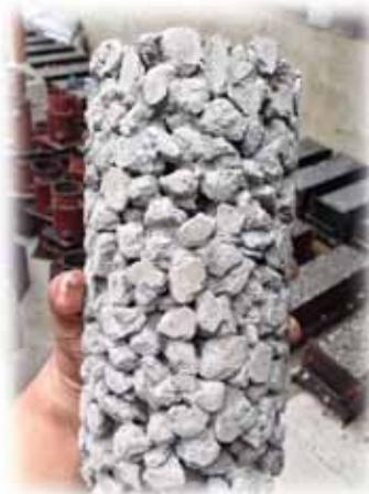
Figura 2.1 – Ilustración del hormigón permeable.
