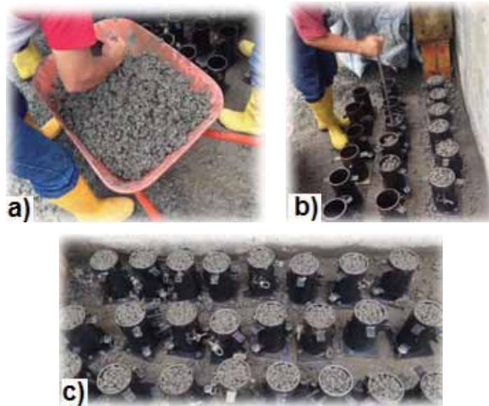
a) Muestreo del hormigón, b) Preparación de las muestras en probetas cilíndricas,
