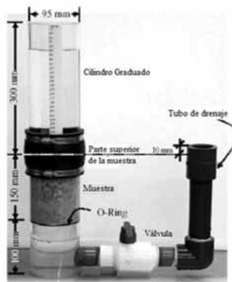
Figura 2.14 – Permeámetro de carga variable
