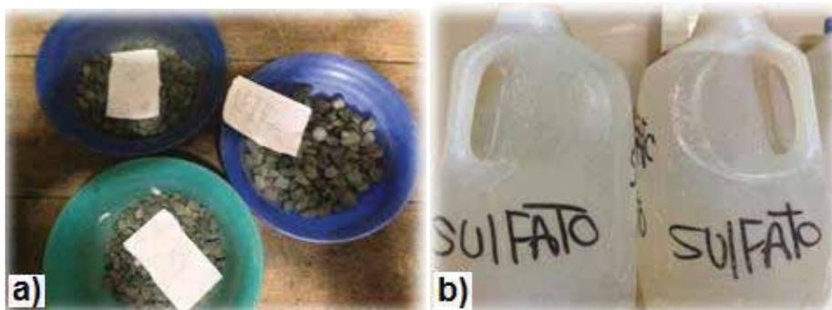
a) Muestras para ensayo de sulfato, b) Canecas con sulfato de magnesio.
