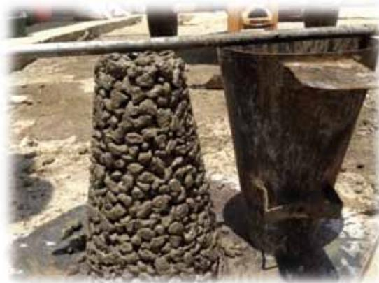
Figura 2.6 - Hormigón permeable en estado fresco.
