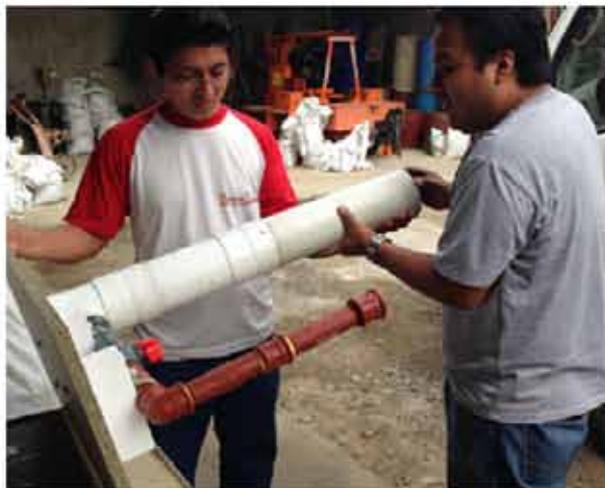
COLOCACIÓN DE LA MUESTRA DE HORMIGÓN (CILINDROS) EN PERMEÁMETRO
