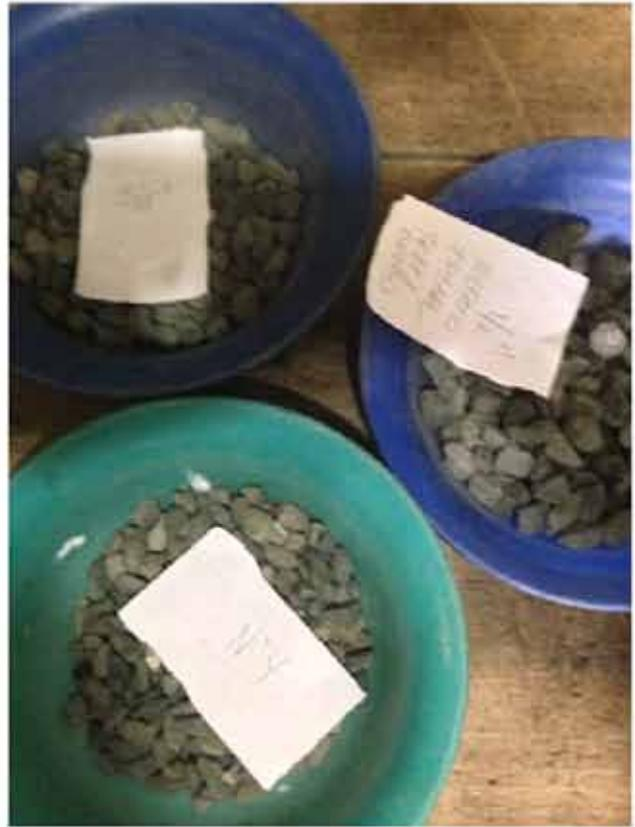
ENSAYO DE SULFATO - PIEDRA
