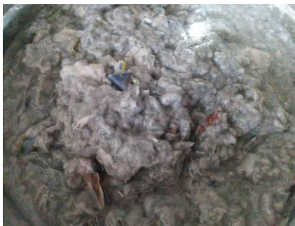
Gráfico 18 y 19. Pulpa del papel colocado en agua y la mezcla con el cemento.
