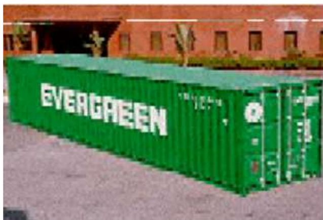
Para usos generales y carga sólida. Tienen 8 pies de ancho (2,4m.) por lo que el centro de carga está a 48 pulgadas (1200 mm).
